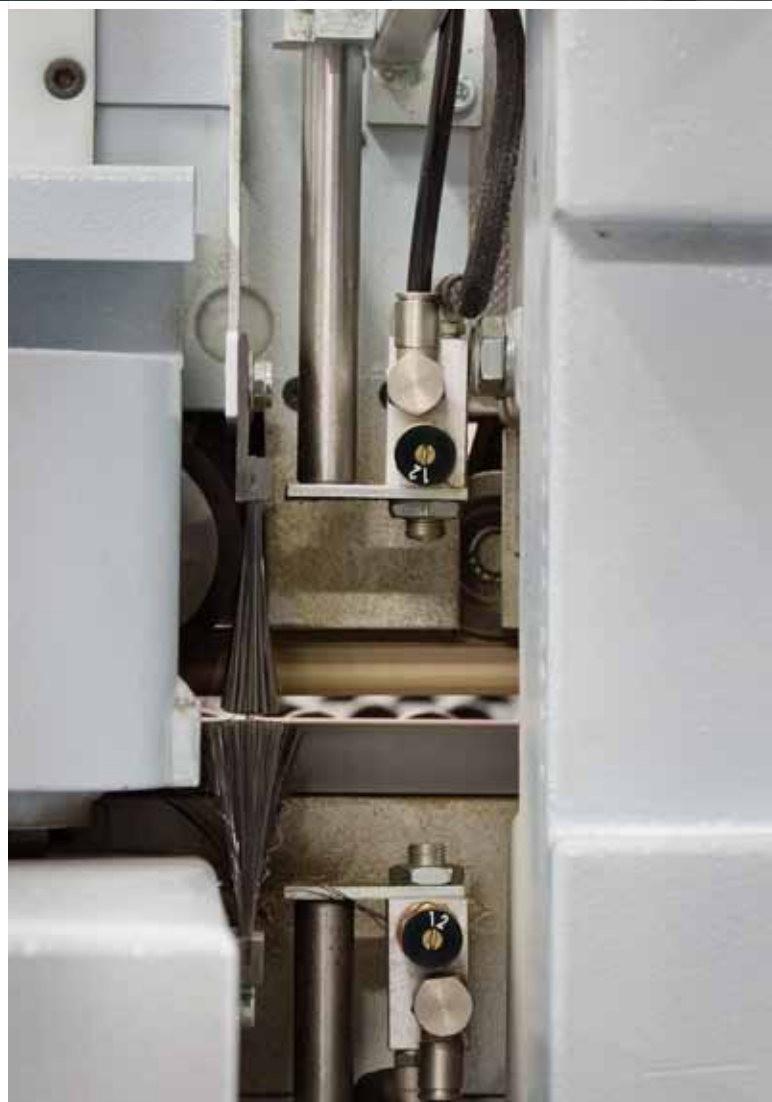
2 Система распыления разделительной жидкости внутри кожуха
