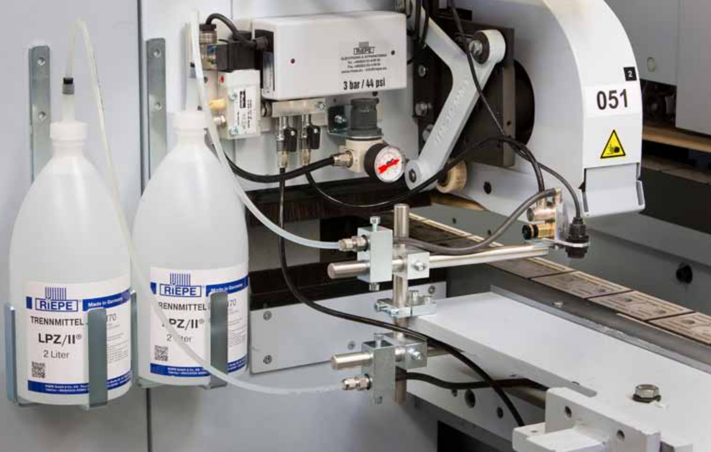
1 Система распыления разделительной жидкости снаружи кожуха, на направляющей
