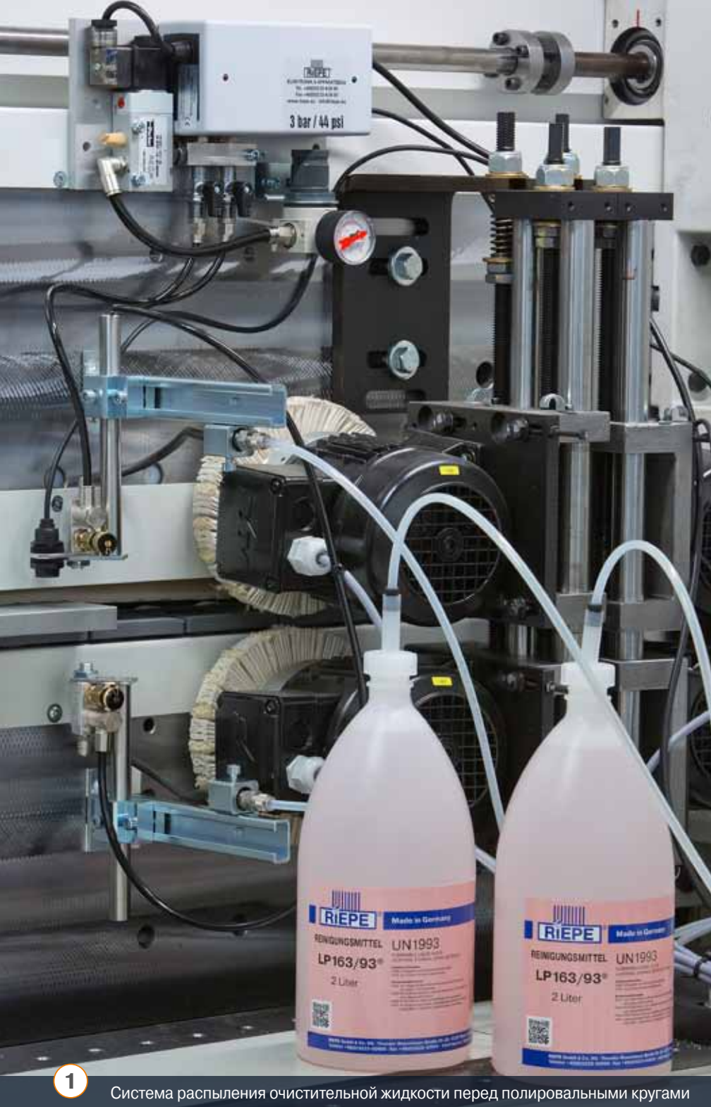
2 Система распыления очистительной жидкости перед циклями
